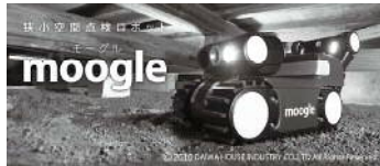
床下点検ロボ moogle
