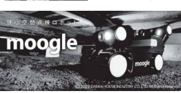
狭小空間点検ロボット 床下を隅々まで点検
